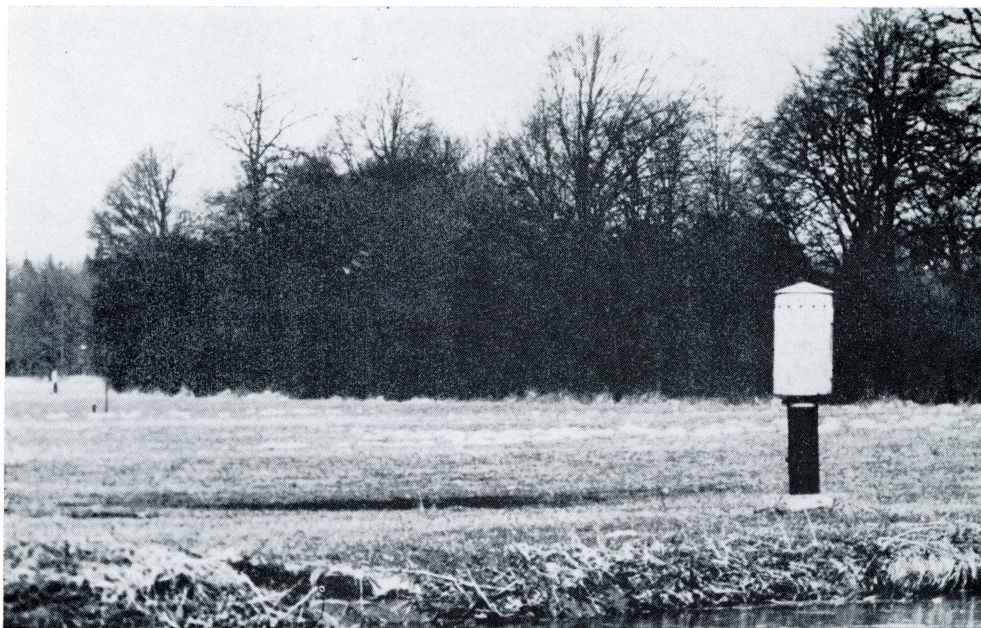
5. Pozorovací vrt základní sítě Hydrometeorologického ústavu. (Foto 1—5 H. Kříž)
