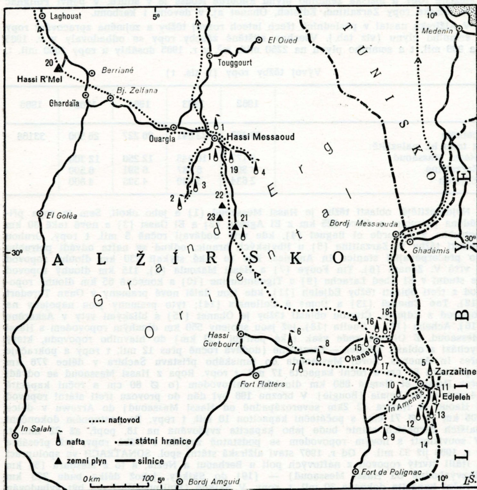
1. Těžba ropy a zemního plynu v Alžírsku (čísla v mapce označují střediska těžby, popsaná jmenovitě v článku).
